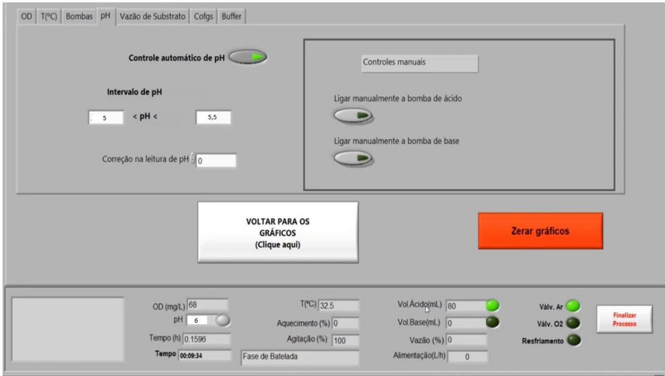
18. Na configuração, manter a aba "Ativar Status do Sistema" pressionada irá exibir na tela do canto inferior esquerdo indicadores quando alguma variável estiver fora dos parâmetros.
